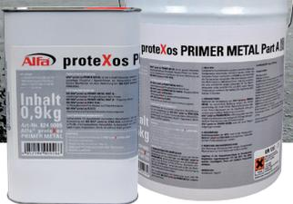
**Alfa proteXos PRIMER METAL** – Der zweikomponentige Phosphat-Epoxidprimer für metallische Untergründe sollte innerhalb von 24 Stunden (bei 60% rel. Feuchtigkeit) nach Vollendung der Oberflächenvorbereitung aufgebracht werden, um „Flugrost“ zu vermeiden.
