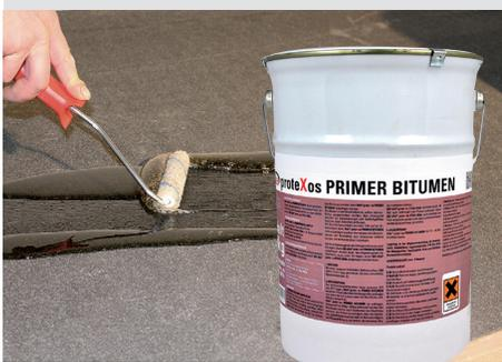
**Alfa proteXos PRIMER BITUMEN** – Der einkomponentige Primer für Bitumenbahnen (mit sandeter/ unbesandeter/ beschiefelter Oberfläche) sollte mit einem Pinsel oder einer Walze aufgetragen werden. Die Verarbeitungstemperatur muss zwischen +5°C und +25°C liegen. **Alfa proteXos PRIMER BITUMEN** darf beim Auftragen nicht weniger als 0,2-0,3kg/m<sup>2</sup> betragen. Die Reichweite kann je nach Unebenheit der Oberfläche variieren.
