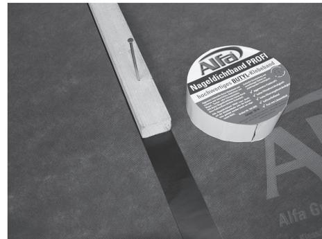
Alfa Nageldichtband PROFI 120 wird zwischen Dachbahn und Konterlattung eingesetzt und dichtet Nagel-/Schraubstellen in der Dachbahn ab.
