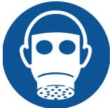
Liegt die Lösemittelkonzentration über den MAK-Grenzwerten, so muss ein für diesen Zweck zugelassenes Atemschutzgerät getragen werden. Halbmaske mit Kombinationsfilter mindestens Filterklasse A1P2 oder fremdbelüftete Atemschutzmaske.
