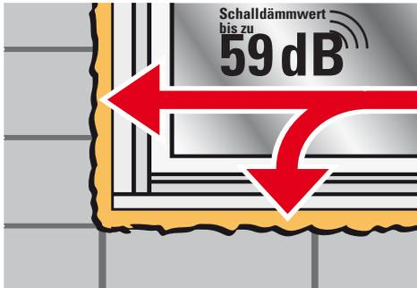
Alfa®PU-Montageschaum (feuchtigkeitshärtend) weist ausgezeichnete Dämm- und Isolierungseigenschaften auf und bietet sehr gute Haftung auf fast allen Werkstoffen wie z.B. Holz, Beton, Porenbeton, Ziegelstein, Metall, Aluminium usw. ausgenommen Polyethylen, Silikon und Teflon.
