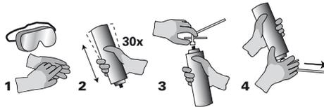
**Hinweis:** Schaum dehnt sich um 30-50% aus. Hohlräume größer als 5 cm mit mehreren Schichten ausfüllen - jede Schicht zuerst aushärten lassen. Schaumspritzer mit Reiniger, Alfa® Clewo Wipes Duo+ oder Aceton sofort entfernen. Ausgehärteter Schaum kann nur noch mechanisch entfernt werden. Ausgehärteter PU-Schaum ist nicht UV-beständig - daher nicht längere Zeit frei bewittern. Alfa PU-Pistolenschaum sollte durch Überstreichen, Überkleben, Verputzen etc. vor UV-Strahlung geschützt werden.
