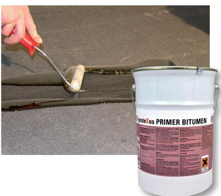
**Alfa® proteXos PRIMER BITUMEN** – Der einkomponentige Primer für Bitumenbahnen (mit besandeter/ unbesandeter/ beschieferter Oberfläche) sollte mit einem Pinsel oder einer Walze aufgetragen werden. Die Verarbeitungstemperatur muss zwischen +5 und +25°C liegen. **Alfa® proteXos PRIMER BITUMEN** darf beim Auftragen nicht weniger als 0,2-0,3kg/m<sup>2</sup> betragen. Die Reichweite kann je nach Unebenheit der Oberfläche variieren.
