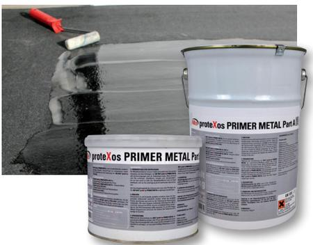
**Alfa® proteXos PRIMER METAL** – Der zweikomponentige Phosphat-Epoxidprimer für metallische Untergründe sollte innerhalb von 24 Stunden (bei 60% rel. Feuchtigkeit) nach Vollendung der Oberflächenvorbereitung aufgebracht werden, um „Flugrost“ zu vermeiden. **Alfa® proteXos PRIMER METAL** muss mit mind. 0,15kg/m<sup>2</sup> aufgetragen werden. Das Produkt darf nicht verwendet werden, wenn die Umgebungstemperatur bei weniger als +5°C oder mehr als +25°C liegt.
