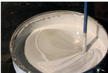
Anwendungstemperatur (Umgebung) zwischen +5 °C und +40 °C. Maximale Umgebungfeuchtigkeit 85 %. Während der Verarbeitung sollte die Temperatur beständig sein oder abnehmen. Im Sommer nicht während der heißesten Zeit des Tages anwenden.
